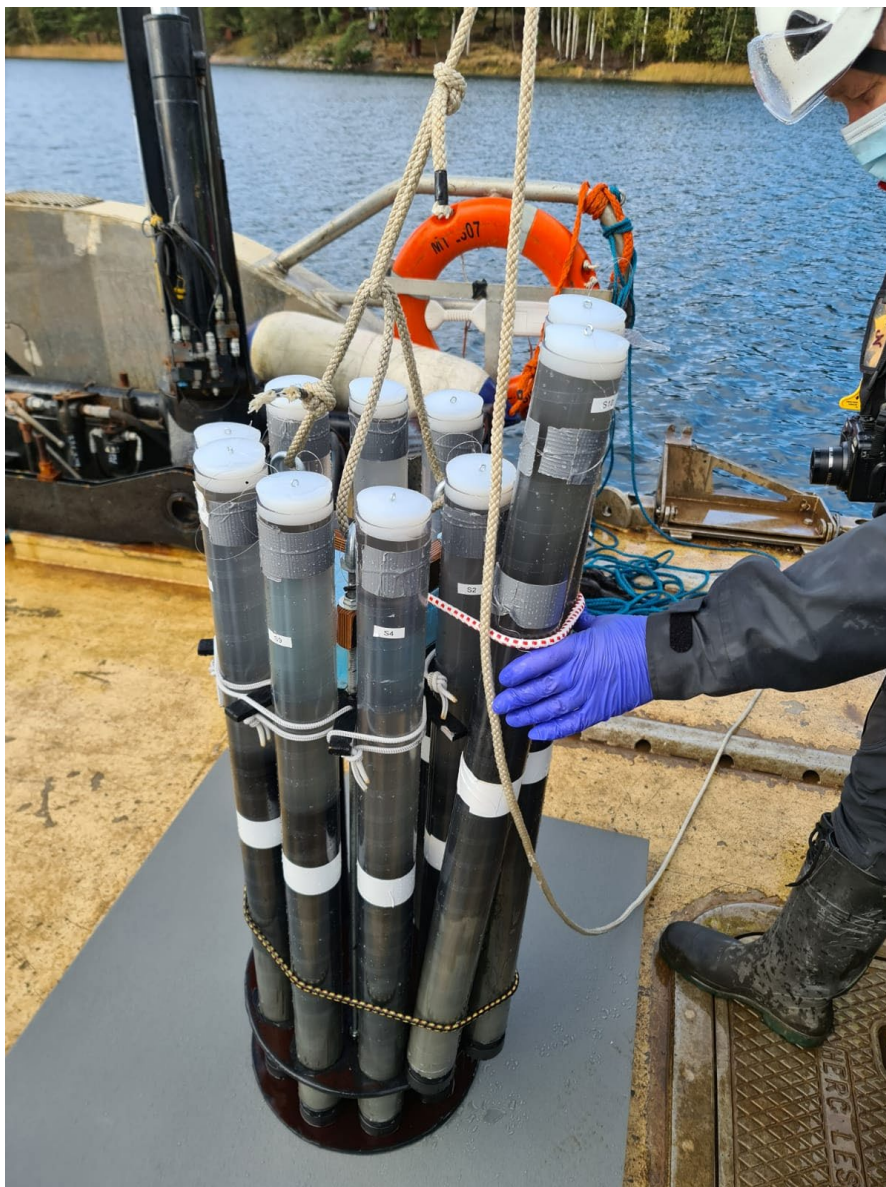
Kuva 4: Näytteet noston jälkeen. Varsinaiset koeyksiköt (S1-S9) ovat telineessä paikoillaan. Kaksi varanäytettä ovat muita korkeammalla kuvassa telineen oikealla reunalla.
