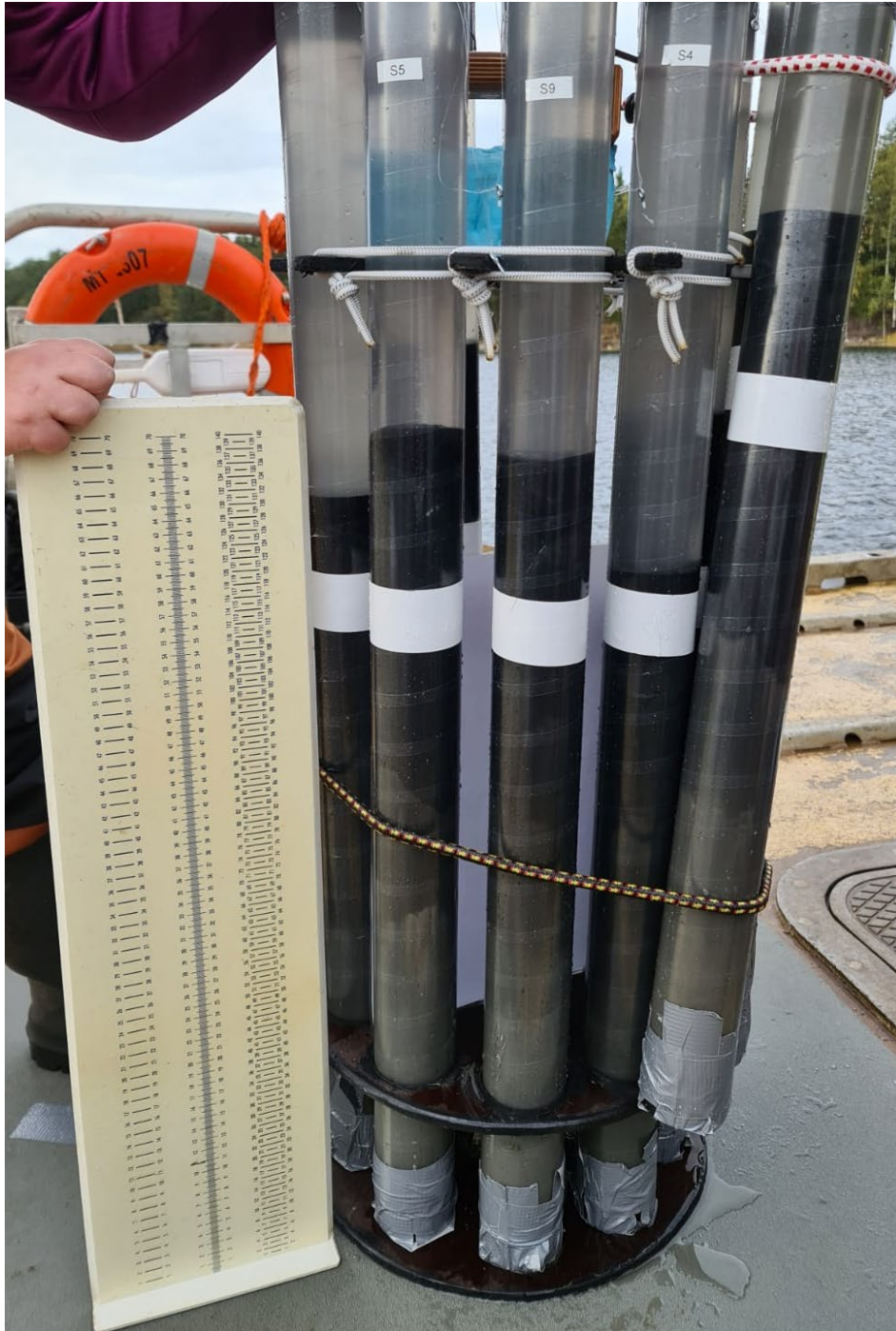
Kuva 5: Lähikuva näytteistä noston jälkeen. Valkoinen teippi osoittaa näytteenoton tavoitteellista sedimenttipintaa. Huonon näkyvyyden takia putkien upottaminen juuri toivotulle syvyydelle ei onnistunut.
